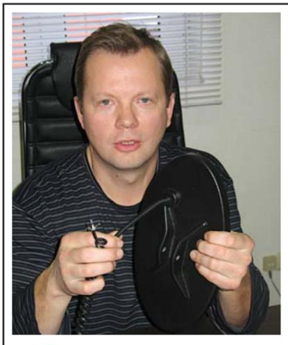
обычный медный провод. Мы применили коаксиальный кабель, это снизило потери слабого сигнала, повысило чувствительность и уменьшило толщину соединительного кабеля (прибор стал лучше складываться при транспортировке).
